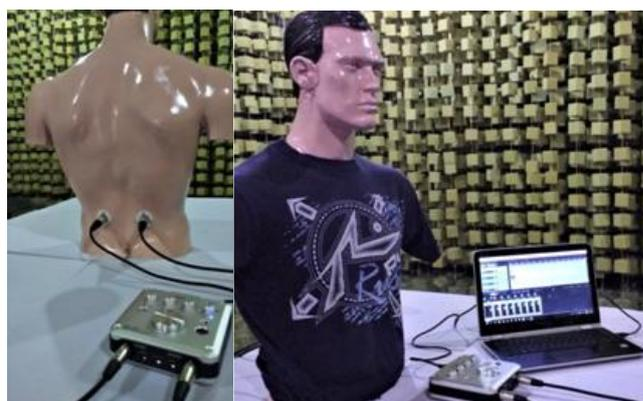
Fig. 5. Conexión entre HATS, placa de sonido y computadora.
