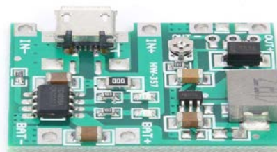
Fig. 4. Circuito comercial utilizado que incluye al cargador de batería TP4056 y al elevador de tensión MT3608.
