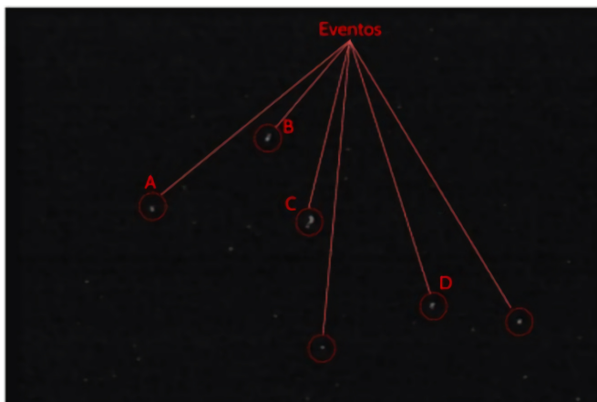
Fig. 1: Ejemplo de detección de eventos de radiación (traza de partículas) sobre la imagen capturada [5].
