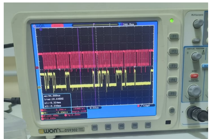
Fig. 2: Señales del protocolo de configuración del transductor optoelectrónico CMOS observadas en el osciloscopio.
