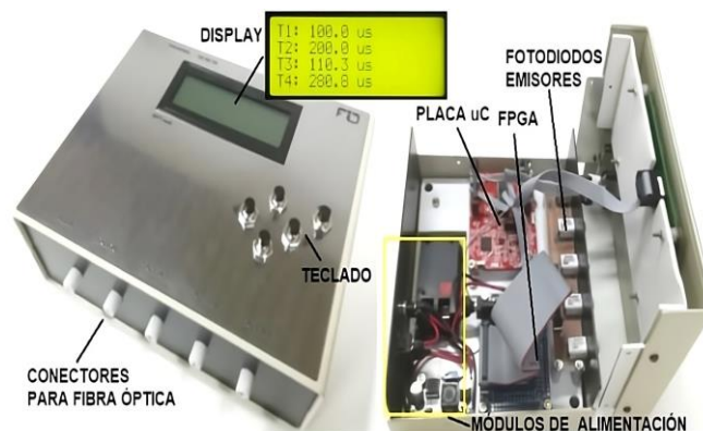
Fig. 4. Partes constitutivas del SOD y montaje.
