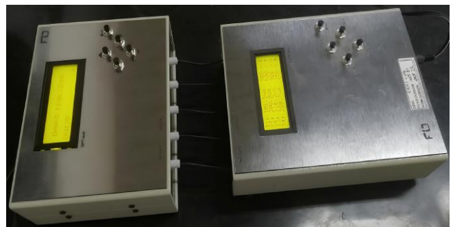
Fig. 9. Empleo del SOD (izquierda) para contrastar un medidor de VOD (derecha).
